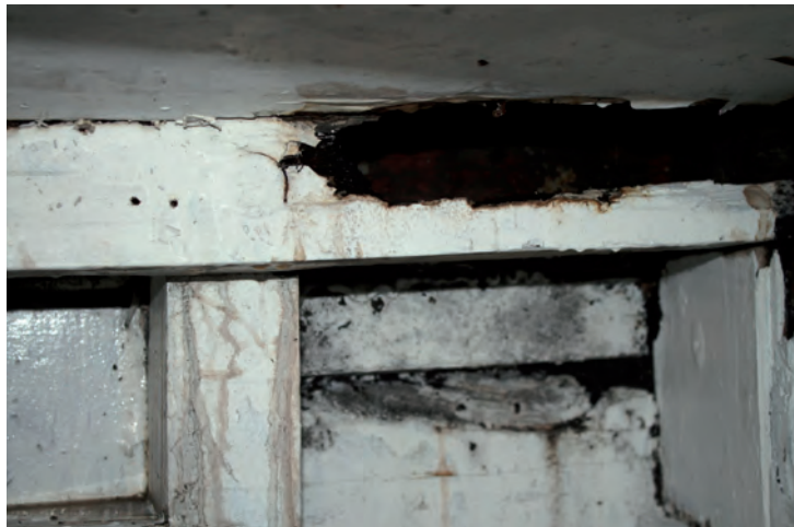
Figura 8 Un dormiente con problemi di infiltrazioni dalla coperta e conseguente attacco biotico (scheda 5.1.6B).
